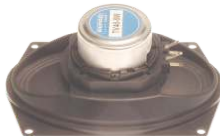
TV46-6W 4X6" 6W 8 ohms Distancia taladros 90x118 mm. Medida total 93x96 mm.
