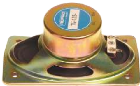
TV135-10W 3X5" 10W 8 ohms Distancia taladros 53x107 mm. Medida total 75x130 mm.
