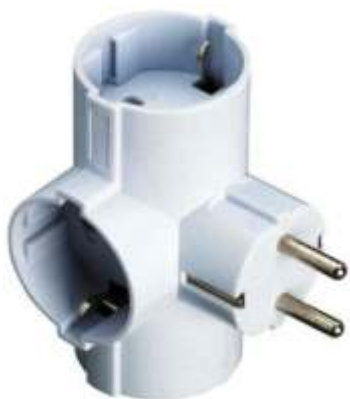
B1101071/B (con blister) Clavija triple con T/T 16 A. 250 V Con obturador Espigas de 4,8 mm.
