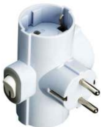
B1101072/B (con blister) Clavija triple con T/T 16 A. 250 V. Con obturador e interruptor Espigas de 4,8 mm.
